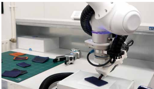
Robot en cours d'abrasion d'un échantillon de cuir sur un poste de maroquinier
