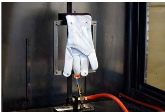
Test de comportement au feu d'un gant de protection
