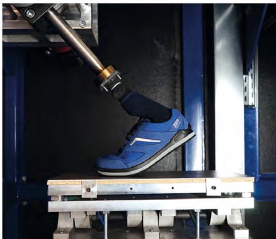
Essai de simulation de la course à pied
