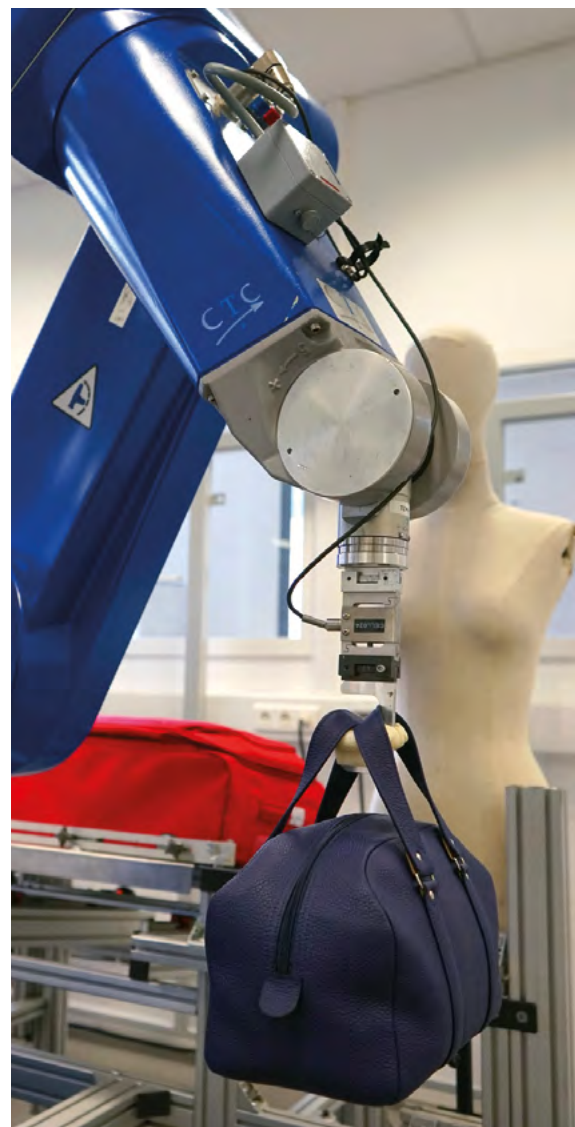
Test robotisé de tenue d'une anse de sac
