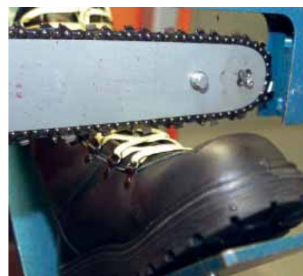
Essai de scie à chaîne sur une chaussure de sécurité
