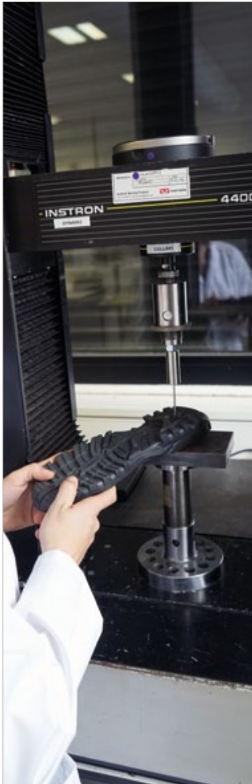
Essai de résistance à la perforation
